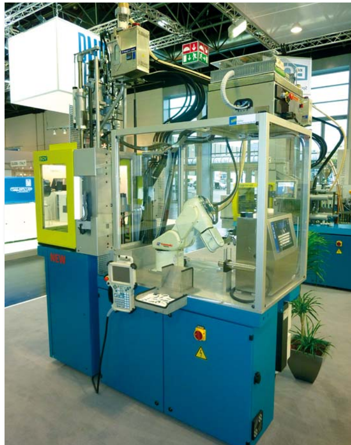
Nebenstehend: Der Umspritzautomat BOY 35 E VV mit integrierter Automation auf dem Maschinengestell
