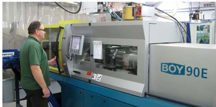
Qualitätsmanagement-Beauftragter Reinhard Wollenberg beim Überprüfen des aktuellen Stromverbrauchs der BOY 90 E.
