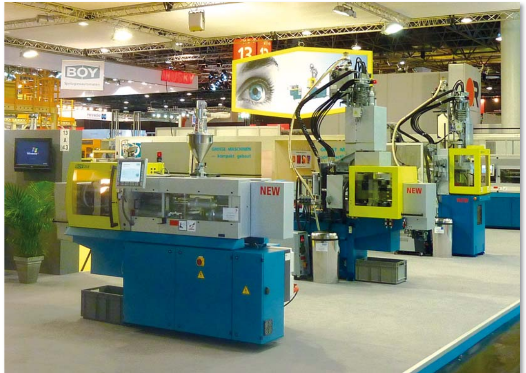
Im Vordergrund die neue BOY 35 E mit optionalem servoelektrischen Schneckenantrieb. Daneben die neu ins Programm aufgenommene BOY 35 E HV mit vertikaler Spritzeinheit zur Trennebenen-Einspritzung.
